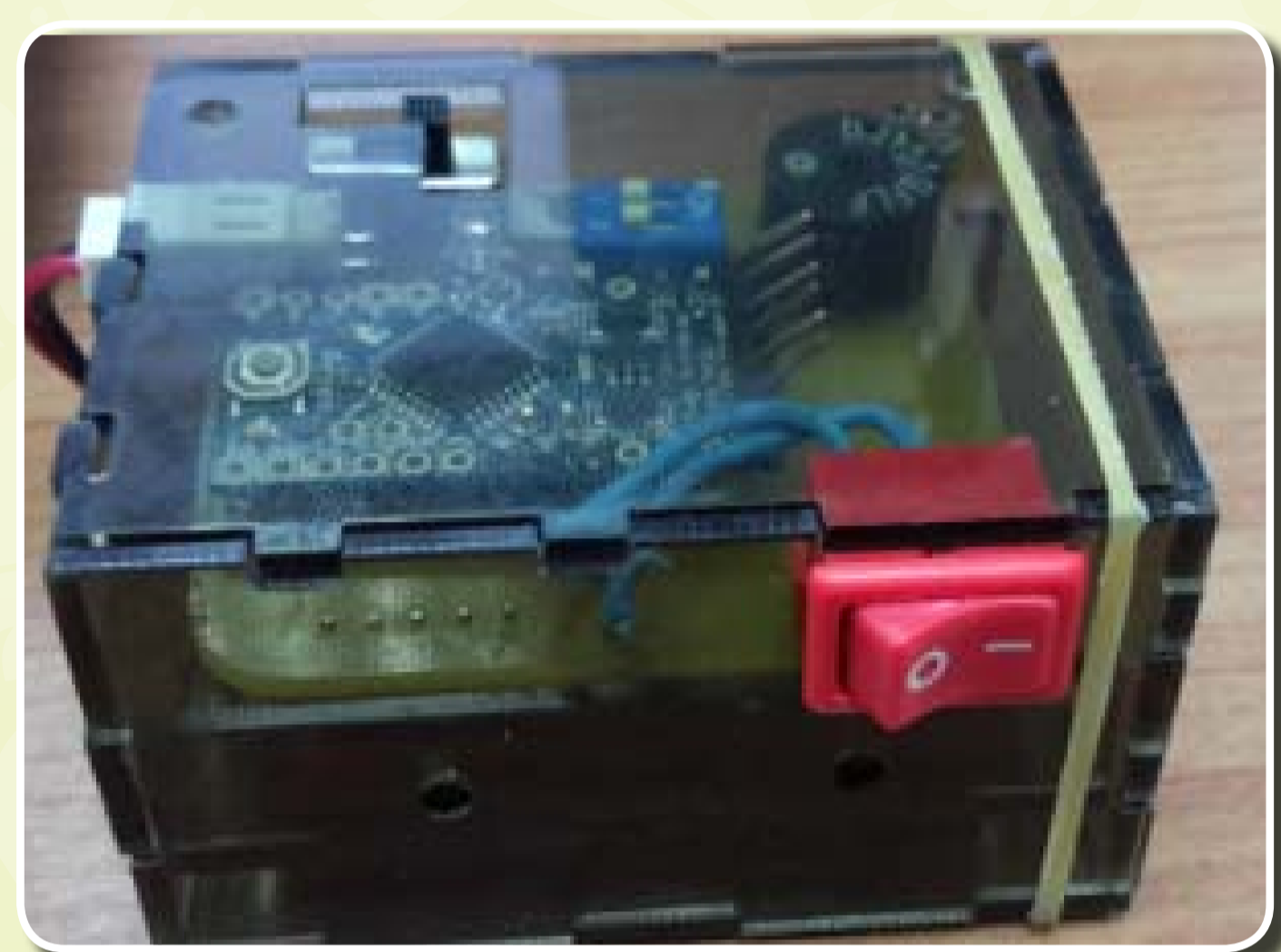
เครื่องตรวจจับการล้มโดยใช้ แบบจำลองการทำนายเชิงเส้น มหาวิทยาลัยเชียงใหม่
