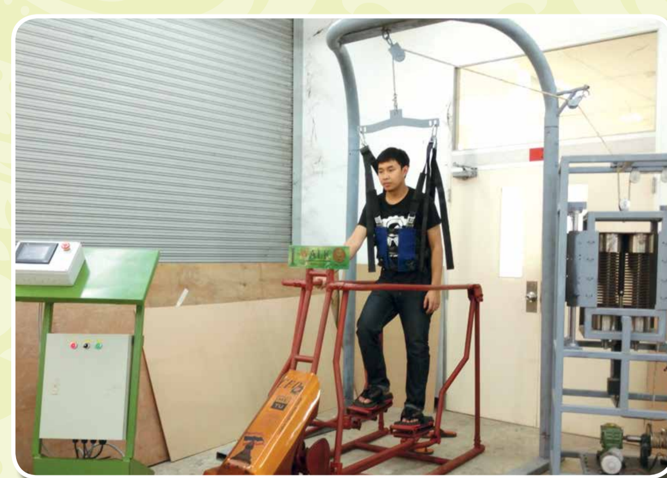
I-Walk อุปกรณ์ช่วยฝึกเดิน สำหรับผู้ป่วยอัมพาตครึ่งซีก มหาวิทยาลัยธรรมศาสตร์
