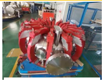
plasma chamberล้อมรอบด้วยขดแม่เหล็ก(toroidal coil)
