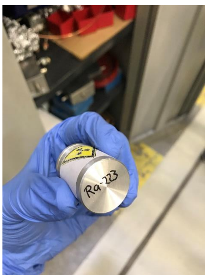
(ซ้าย) แหล่งกำเนิดกัมมันตภาพรังสี (ขวา) แหล่งกำเนิดกัมมันตภาพรังสีภายในเครื่อง buffer gas cell
