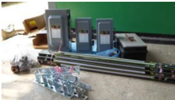
ตัวอย่างอุปกรณ์ที่นำไปติดตั้ง (safety switch จำนวน ๓ ตัว, หลอด LED T18)
