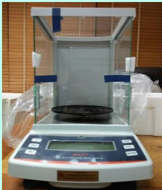
เครื่องชั่งไฟฟ้าสำหรับ วิเคราะห์ 0.01 g จำนวน 2 เครื่อง
