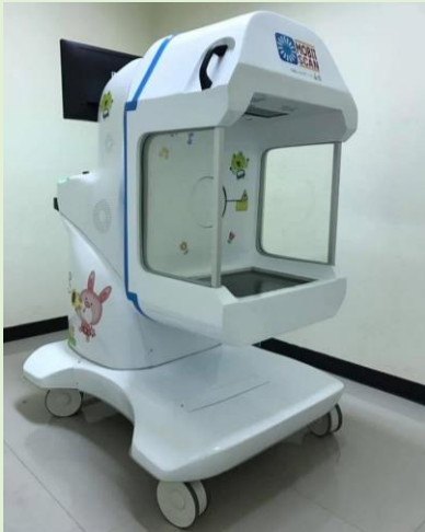
MobiiScan (MibileCT): เครื่องซีทีสแกน 3 มิติแบบเคลื่อนย้ายได้
