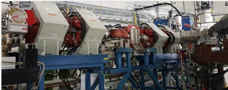
ขั้วควอดรูโพล (Quadrupoles) ทำหน้าที่โฟกัสลำแสงไอออนก่อน ลงเข้า CRYRING
