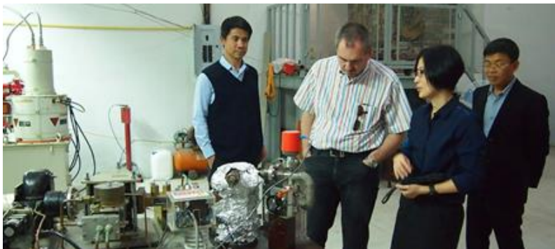
เครื่องเร่งอิเล็กตรอนเชิงเส้นสำหรับการวัดค่าในชั้นนำยางธรรมชาติ
