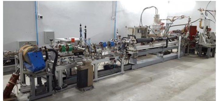
CMU-FEL ความยาวราว 15 เมตรผลิตเลเซอร์ย่านไมโครเมตร (อินฟราเรดย่านกลาง)-มิลลิเมตร(เทราเฮิร์ตซ์)
