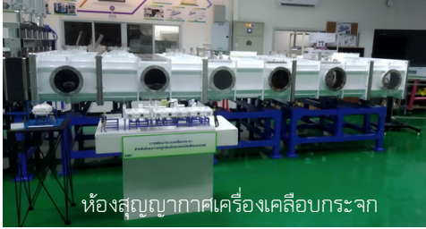
หัว sputtering เคลือบกระจกในห้องสุญญากาศ
