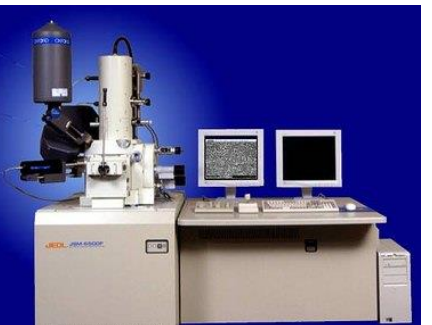
กล้องจุลทรรศน์ที่ใช้อิเล็กตรอนแทนการใช้แสงในการให้เกิดภาพ
