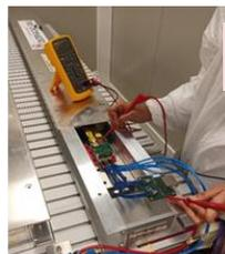
การตรวจสอบทางอิเล็กทรอนิกส์ก่อนติดตั้ง stave บน Outer barrel
