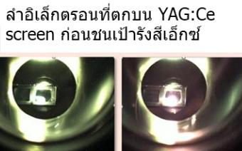
สายอิเล็กตรอนที่ตกบน YAG:Ce screen ก้อนชนเป้ารังสีอิเล็กซ์
