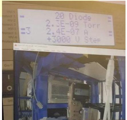
วัดอัตราการผลิตรังสีเอ็กซ์และการวัดระดับความดันสุญญากาศ ขณะดำเนินการ Beam aging
