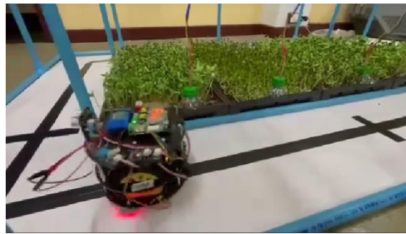
รูปที่ 7 ทดสอบการเดินของหุ่นยนต์ระหว่างออกวิ่งไปสถานีแต่ละ จุด
