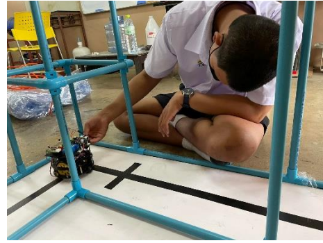
รูปที่ 7 ทดสอบการเดินของหุ่นยนต์ระหว่างออกวิ่งไปสถานีแต่ละ จุด
