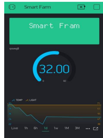
รูปที่ 13 ภาพแสดงค่าอุณหภูมิผ่านจอ LCD และแสดงที่แอปพลิเคชัน Blynk
