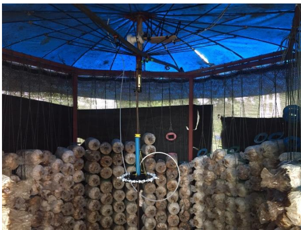
รูปที่ 12 ภาพมอเตอร์นำทำงานโดยมีอุปกรณ์ kick sensor เป็นตัวกำหนดให้มอเตอร์เดินขึ้น-เดินลง
