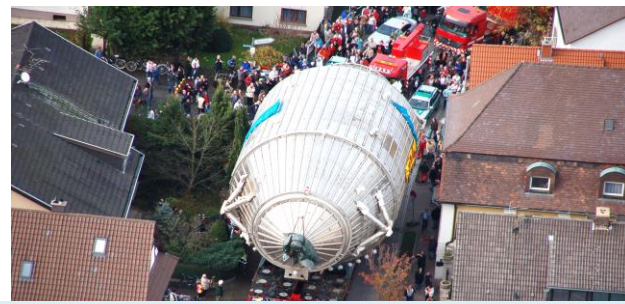
ภายนอกของmain spectrometerเส้นผ่าศูนย์กลาง10เมตรขณะขนส่ง
