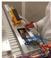
การตรวจสอบทางอิเล็กทรอนิกส์ก่อนติดตั้ง stave บน Outer barrel
