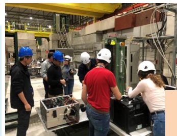
ทดสอบเซนเซอร์ APTS เทียบกับเซนเซอร์อ้างอิง ALPIDE
