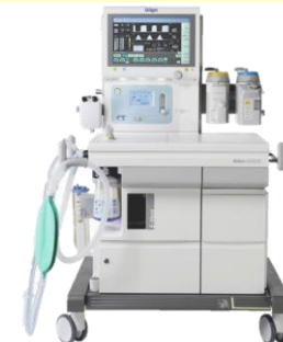
ระบบแสดงผลและบันทึกข้อมูลทางวิสัญญีอัตโนมัติ
