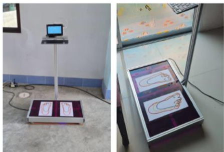
อุปกรณ์ตรวจการรับความรู้สึกบริเวณฝ่าเท้าในผู้ป่วยเบาหวาน
