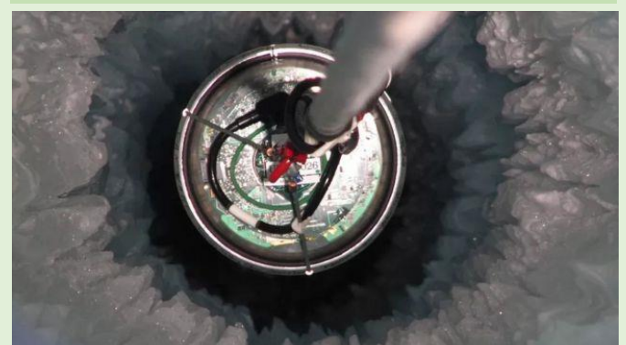
เซนเซอร์ตรวจจับนิวทริโนหลายพันตัวถูกแขวนด้วยสายเคเบิล เพื่อให้ลอยอยู่ในก้อนน้ำแข็งของทวีปแอนตาร์กติกา
