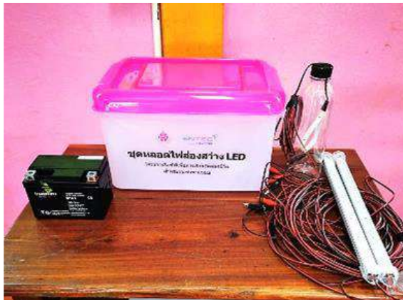
ภาพที่ 4 : กิจกรรมการประดิษฐ์ชุดหลอดไฟส่องสว่าง LED แบบพึ่งพาตนเอง
