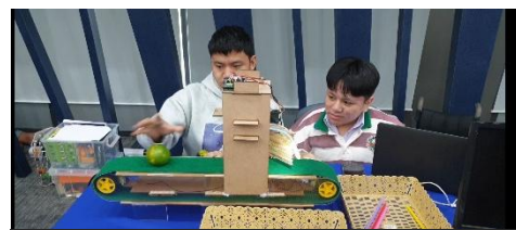
ผลงานโครงงานคัดแยกผลไม้ด้วยบอร์ด KidBright \mu AI
