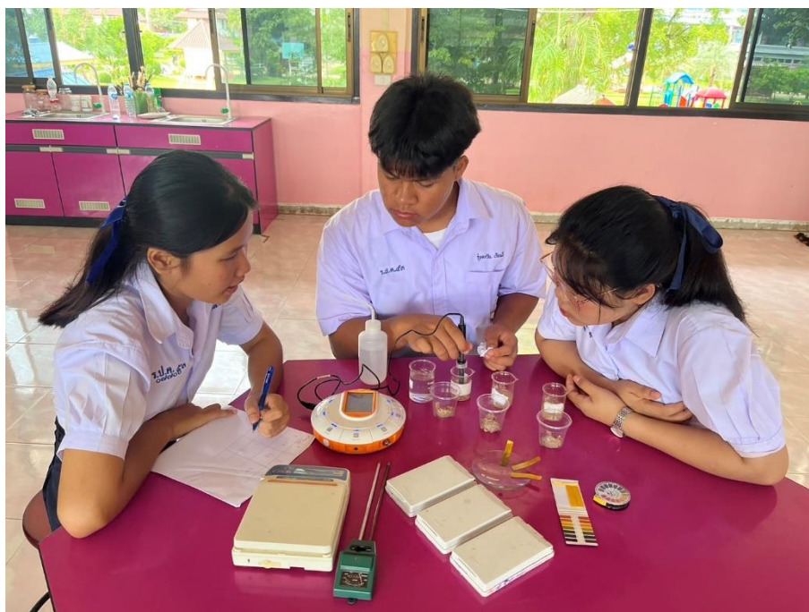
การทดสอบความเป็นกรด-ด่าง โดยใช้เครื่อง Sen Disk
