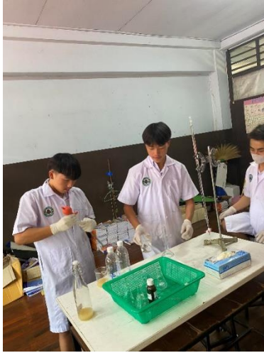
วิเคราะห์ปริมาณกรดแลกติก ด้วยวิธีการไทเทรต
