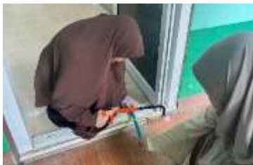
ภาพที่ 2.18 วัดความยาวของท่อ PVC 40*50*40 ตัดตามโครงสร้างที่ออกแบบ
