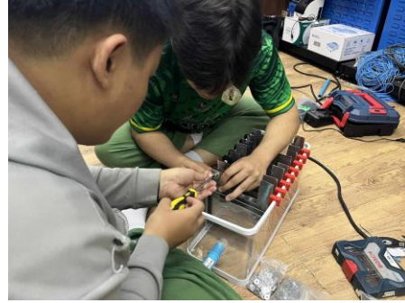
ภาพที่ 6 ประกอบและต่อวงจรสำหรับแผ่นอะลูมิเนียม (แผ่นอิเล็กโทรด)
