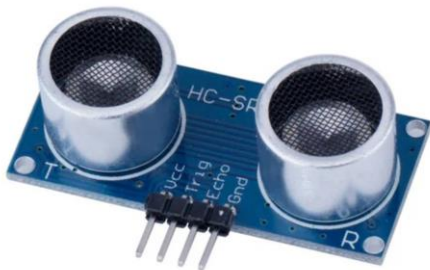
ภาพที่ 2 ,เซ็นเซอร์ Ultrasonic,"มีลักษณะคล้าย ""ดา"" สองข้าง (T และ R)", "ใช้ส่งคลื่นเสียงไปกระทบผิวน้ำเพื่อวัด ""ระยะห่าง"" ทำให้เรารู้ว่าระดับน้ำสูงขึ้นเท่าไรแล้ว"
