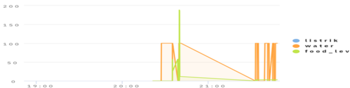
ภาพที่ 3 กราฟแสดงการทำงานของระบบ ไฟฟ้า (listrik), น้ำ (water) และ ระดับอาหาร (food_lev) ตามช่วงเวลา (แกนแนวนอน) โดยแกนตั้งแสดงค่าการทำงานหรือปริมาณที่ตรวจวัดได้
