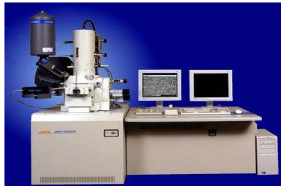
กล้องจุลทรรศน์ที่ใช้ไอเล็กตรอนแทนการใช้แสงในการให้เกิดภาพ
