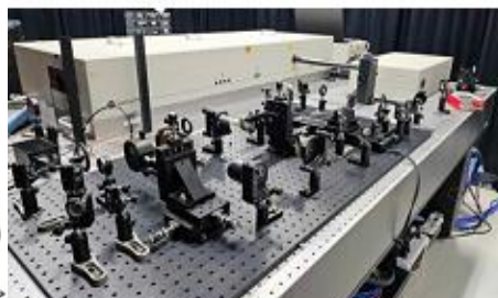
สร้างระบบวัดสเปกตรัมย่านเทระเฮิร์ตซ์โดยใช้เลเซอร์เฟมโตวินาที
