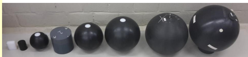
ชุดเครื่องตรวจวัดพลังงานนิวตรอนของโบนเนอร์ที่ GSI
