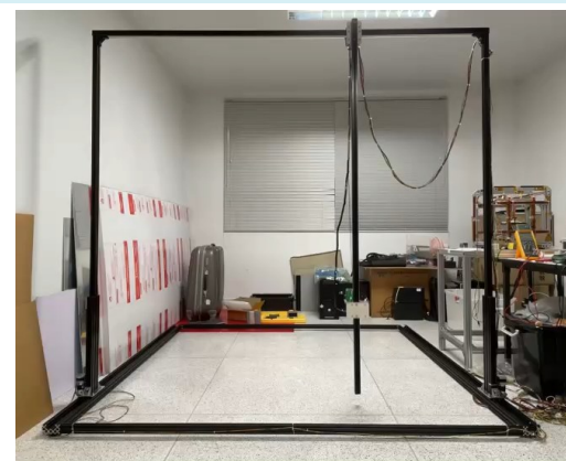
การเคลื่อนที่ของ sensor จริงตามแนวแกนและหัววัดสนามแม่เหล็ก ซึ่งจะถูกนำไปใช้ภายในห้องทดสอบประสิทธิภาพ PMT
