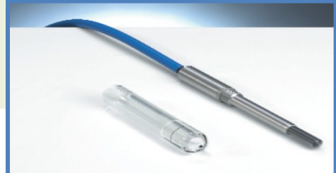
รูปที่ 2 หัววัดรังสีแบบมาตรฐานที่ใช้ในศูนย์รังสีรักษา แต่ทว่ามีปัญหาเมื่อถูกใช้ในการวัดรังสีที่มีการถ่ายเทพลังงานอย่างรวดเร็ว
