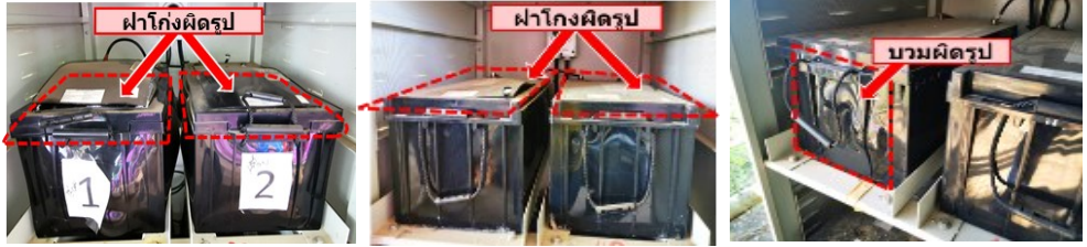
ลักษณะภายนอกแบตเตอรี่ Lead Acid ที่เสื่อมสภาพ
